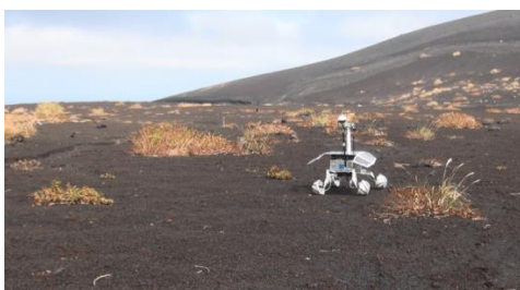
<写真 1:回避走行試験>
